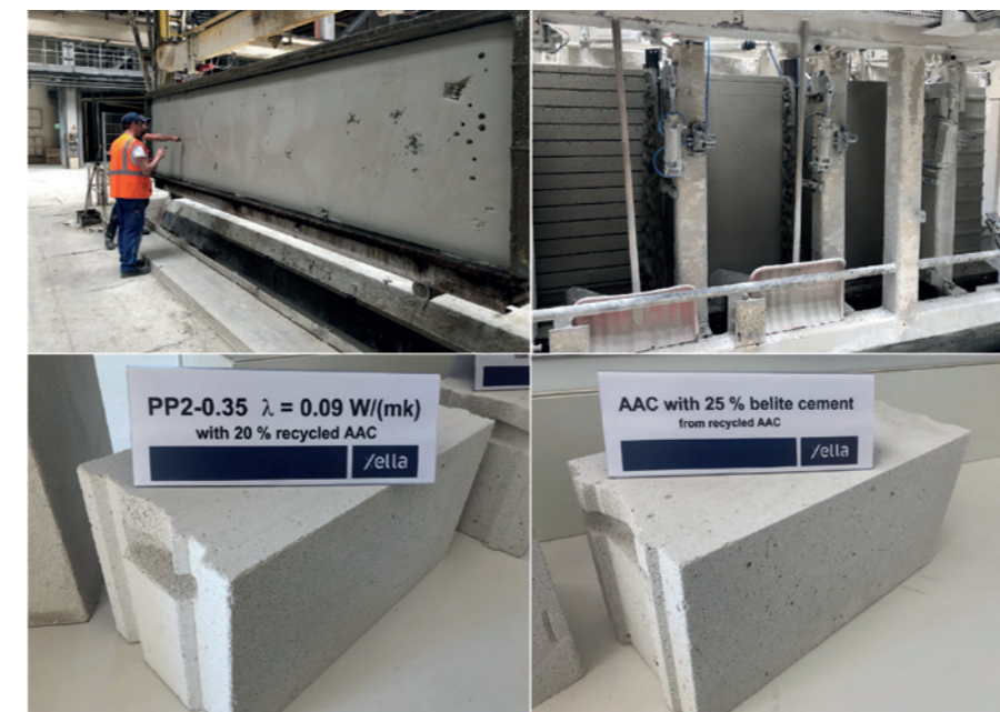
Abbildung 15: Herstellung von Porenbetonprototypen im Großtechnikum der Xella Technologie- und Forschungsgesellschaft mbH; unten links: Porenbeton Planblock Ytong® PP2-0,35 mit 20 % Anteil an Altporenbeton; unten rechts: Porenbeton Planblock mit RC-Zementklinker (Belit) aus Altporenbeton (Quelle: Xella Technologie- und Forschungsgesellschaft mbH)
