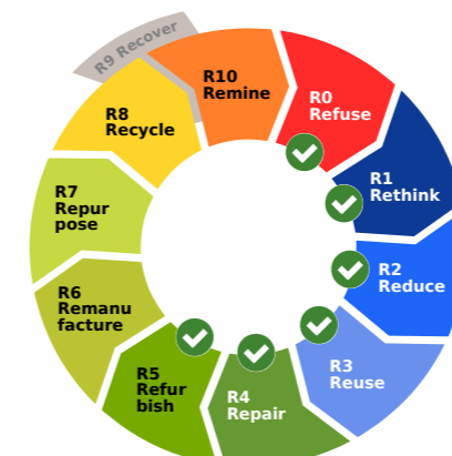
Abbildung 20: R-Strategien zur Verbrauchsreduzierung von natürlichen Ressourcen und Schließung von Stoffkreisläufen mit Kennzeichnung derer, die von dem Forschungsprojekt „PERMA“ abdeckt werden (Quelle: in Anlehnung an Kirchherr et al. (2017) und Potting et al. (2017)).
