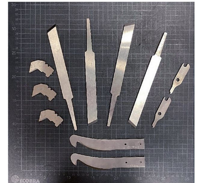
Abbildung 19: Entnommene und geschliffene Repurpose Produkte (Quelle: Bergische Universität Wuppertal)
