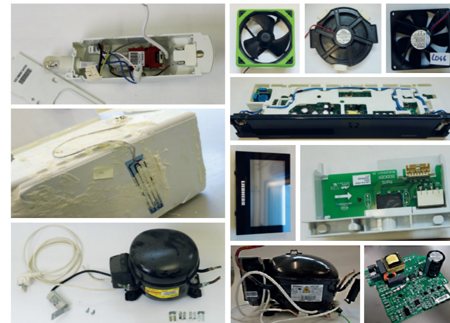
Abbildung 31: Vergleich des Anteils elektr(on)ischer Komponenten in Kühl-/Gefriergeräten, Baujahr ca. 2000 (linke Abbildungen), Baujahr 2019 (rechte Abbildungen) (Quelle: Eigene Abbildung HZDR, M. Heibeck, 2021).
